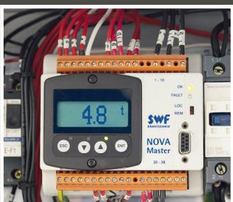
SWF Novamaster, unità di monitoraggio del funzionamento della gru che ne elabora i dati principali di utilizzo proteggendo dall'usura i componenti meccanici e garantendone affidabilità e sicurezza.
