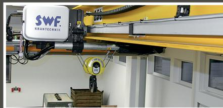
Alimentazione paranco con catena portacavo in sostituzione del festone in package con il radiocomando. Gru innovativa e sicura senza cavi a vista.
